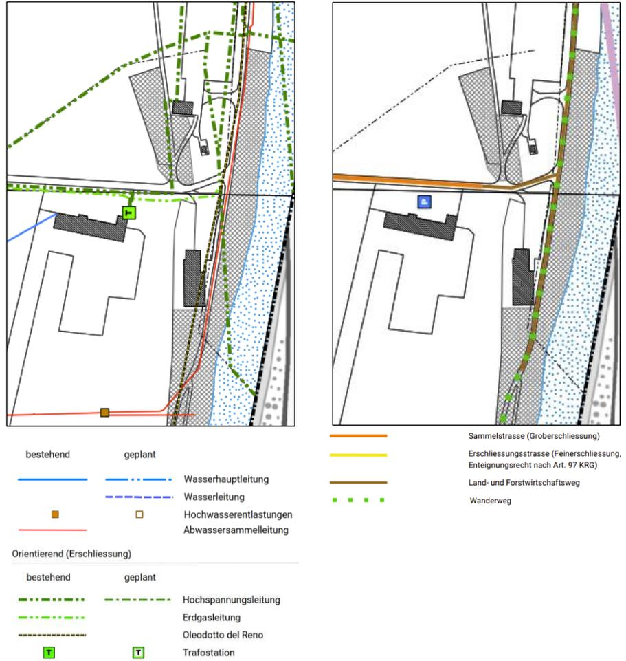
**Abb. 8:** Genereller Erschliessungsplan Ver- & Entsorgung (26.08.2024)
